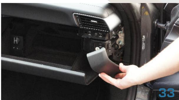
**Der Verbau der Antenne ist auch ohne Demontage des Handschuhkastens möglich ist. Dies liegt im Ermessen des Technikers.**
